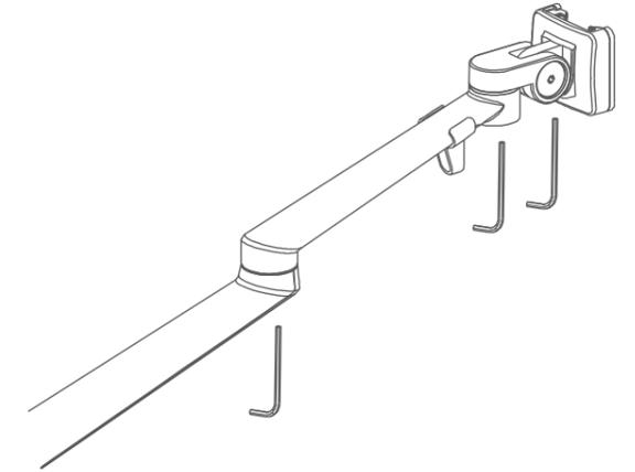
Si la friction est trop forte ou trop faible lors de l'élévation ou de la rotation du dispositif, veuillez utiliser une clé pour ajuster la vis.
