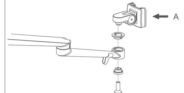
Remarque : si vous souhaitez modifier le sens d'inclinaison du bras et ainsi diminuer la hauteur, veuillez détacher le support du bras (A) et le mettre à l'envers. Puis insérez et fixez le bras comme indiqué sur la figure ci-dessus.
